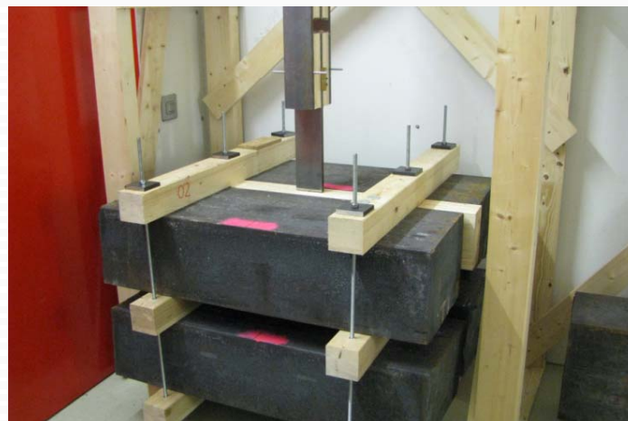
Abb.: Prüfanordnung mit aufgebracht 4-Tonnenlast
