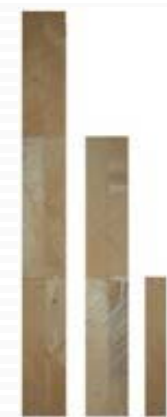
Abb.: Aufbau der geprüften Träger
