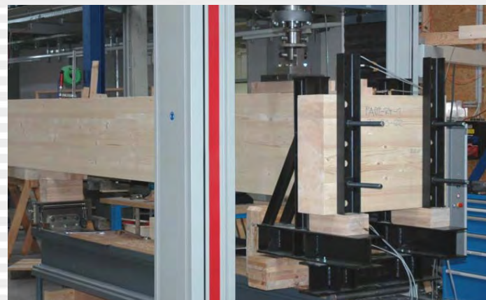
Abb.: Prüfkongfiguration Hauptträger-Nebenträgeranschluss (BSH)
