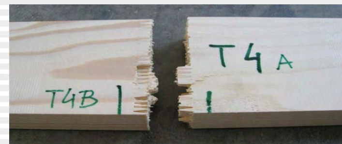
Typisches Versagen der Keilzinkenverbindung auf Zug der merkmalsfreien Brettware der Holzart Tanne (Abies alba Mill.)
