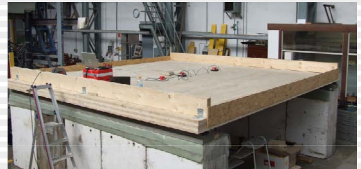
BSP-Deckenplatte bei Schwingungsuntersuchungen an der MFPA Leipzig MA
